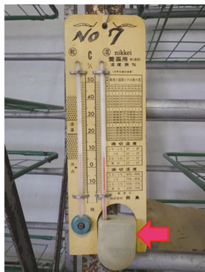
図 6 温湿度計 矢印が水を入れる容器 温度計と湿度計の差から湿度が分かるように表がついている。
