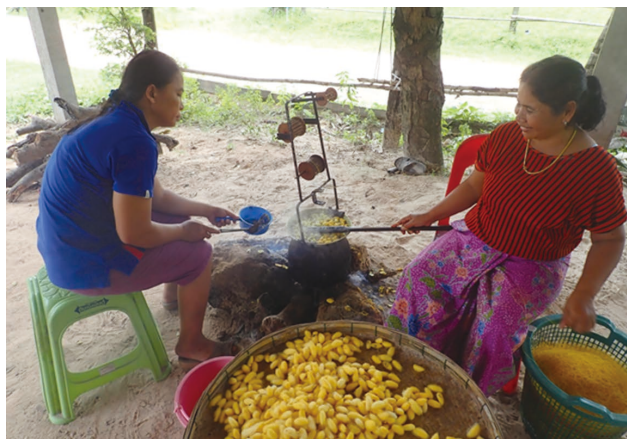
図1 繰糸作業風景 2人一組で作業。糸枠は使わず、籠に繰った糸を貯める。
